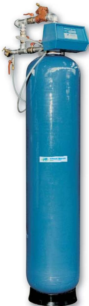
L'adoucissement élimine, par passage sur des résines échangeuses d'ions, le calcium et le magnésium dont les sels produiraient l'entartrage des circuits et des équipements.
